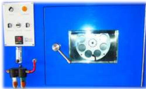
Fig. 1. Horno de Película Delgada Rotacional RTFO
